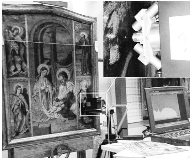
**Fig. 3** – Análisis *in situ* por fluorescencia de rayos X.
