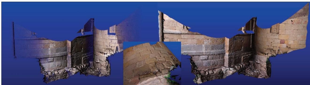
Fig. 1. La imagen de la izquierda se corresponde con la nube de puntos capturada con el escáner. Una vez tratada (dcha), podemos convertir los puntos en un sólido al que aplicamos texturas de alta resolución. Podemos observar el detalle de las oquedades en la piedra.
